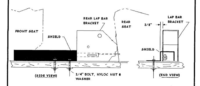
POSITION THE SHIELD SO THAT IT IS AGAINST THE REAR LAP BAR BRACKET AND 3/8" OUT FROM THE FACE OF THE BRACKET (AS SHOWN ABOVE)
